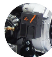
Kontrolna ploča sadrži: ključ za paljenje, indikatore ulja, indikator punjenja baterije
